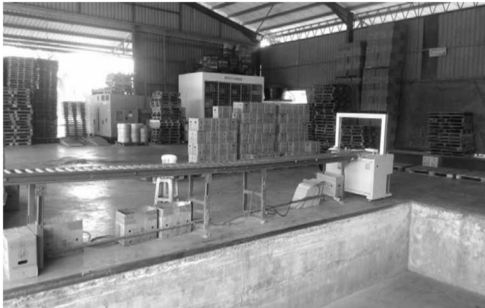
Lampiran 14.5: Conveyor dan bagging machine - bagi pembungkusan buah untuk dieksport ke luar negara (menjimatkan masa dan mengurangkan penggunaan buruh)
