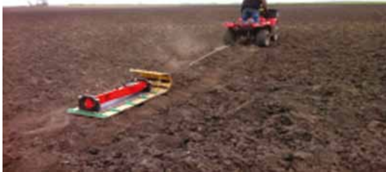
Rajah 13.6: Kaedah pengendalian alat pemetaan tanah elektromagnet
